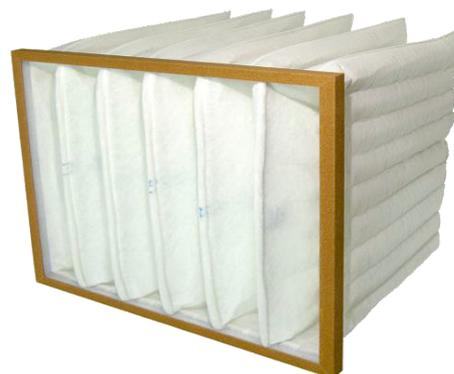
**Applications :** Filtres avec une capacité de rétention de poussière extrêmement élevée, utilisés par exemple pour séparer les fumées de soudage dans les systèmes d'évacuation d'air. Option pour unité de purification d'air Njord, Njord XP-2 et Njord XP-4.
